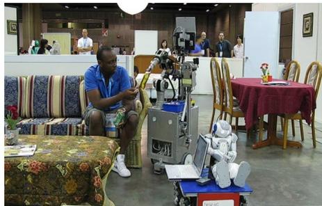
Fig. 1 L'Humanoïde Nono, de type Nao, en bas à droite, assure la médiation entre l'humain et les autres machines (plateforme OP-Y sur laquelle Nono est installé) ; et robot RH-Y qui a apporté boisson et snacks
